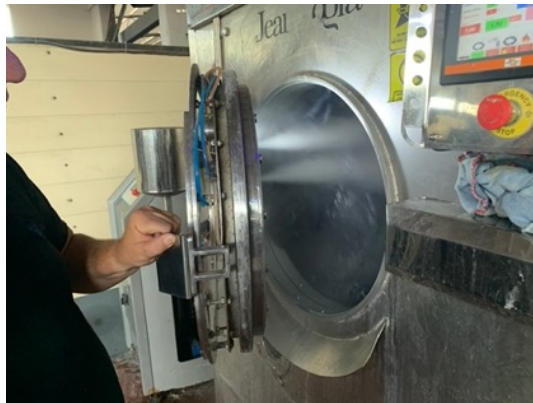
Besuch der Jeans-Wäscherei in Izmir am 20.2.2023; Demonstration der neuen E-Flow Technologie, welche die Waschung durch Dampf ermöglicht und damit bis zu 70% Wasser einspart
