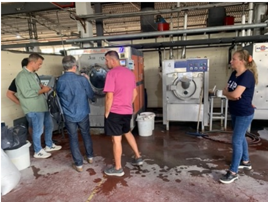
Besuch der Jeans-Wäscherei in Izmir am 20.2.2023; Demonstration der neuen E-Flow Technologie, welche die Waschung durch Dampf ermöglicht und damit bis zu 70% Wasser einspart
